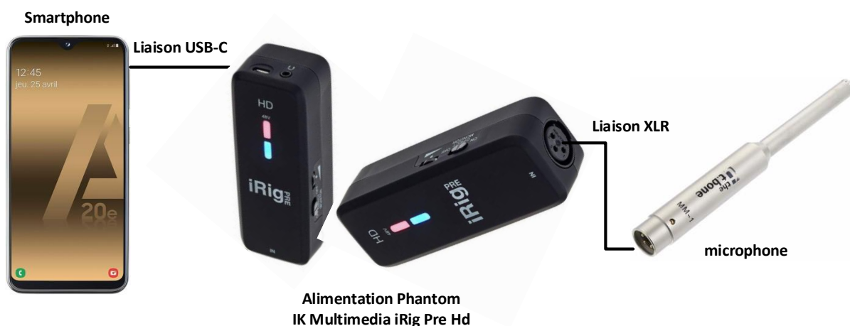
Figure 1 – Dispositif de mesure composé d'un smartphone, d'un microphone the t.bone MM-1 avec son alimentation Phantom IK
